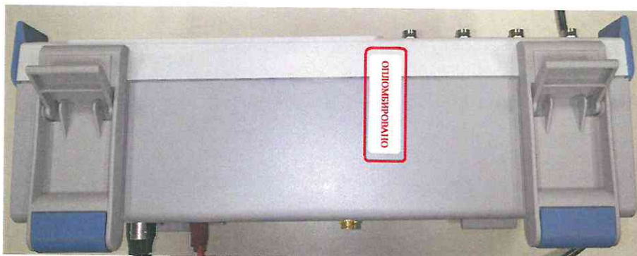
Рисунок 4 – Схема пломбировки от несанкционированного доступа (вид снизу)
