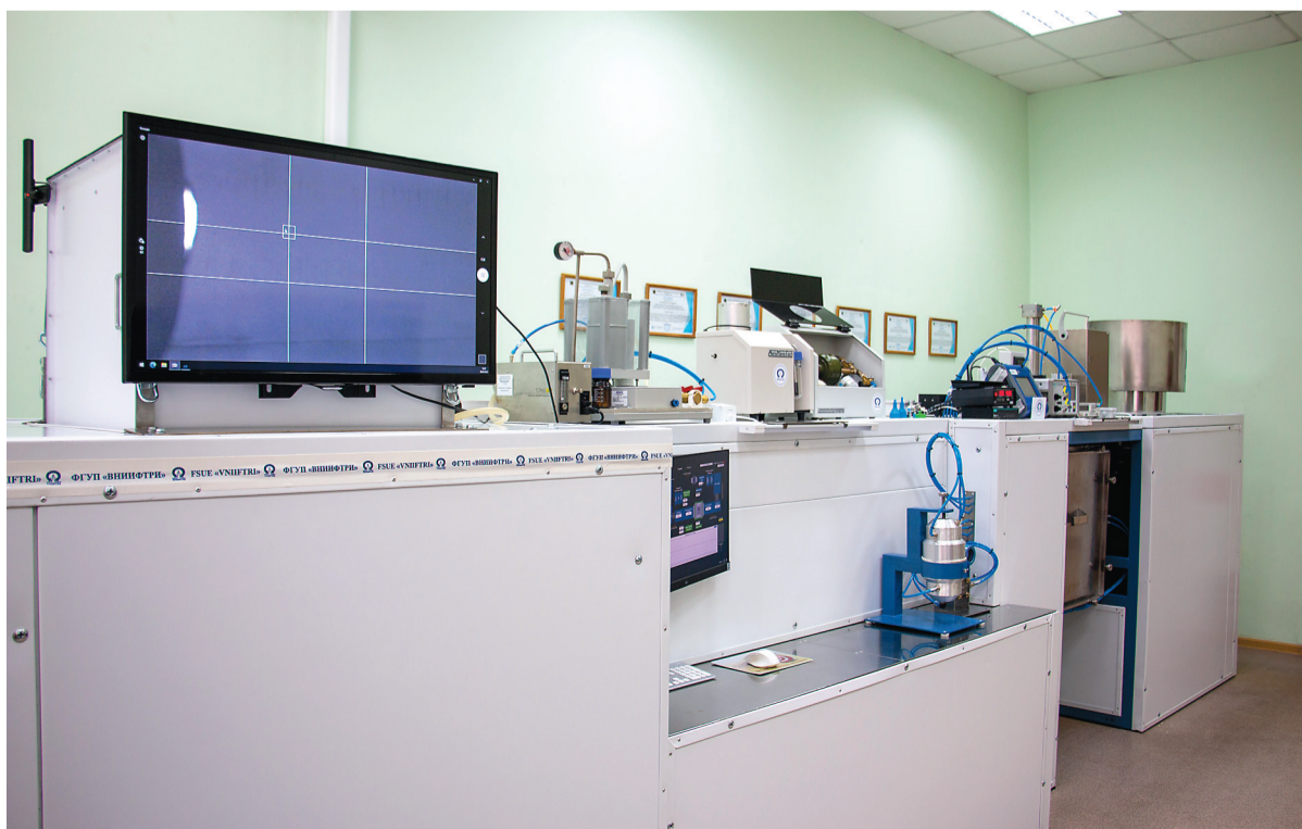
Комплекс аппаратуры измерения эффективности фильтрации аэрозольных частиц фильтрами и фильтрующими материалами
