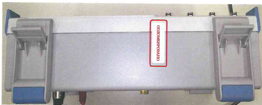
Рисунок 4 – Схема пломбировки от несанкционированного доступа (вид снизу)
