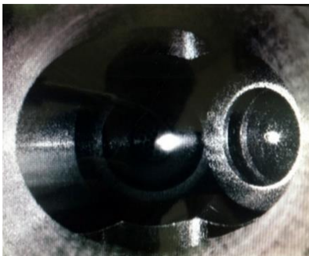
Рисунок 1 – Фотография облака холодных атомов \text{Rb}^{87} во вспомогательной ловушке. В правой части располагается зеркало с отверстием.
