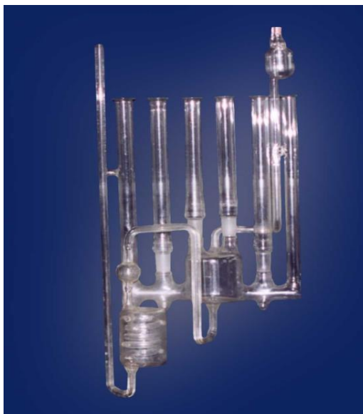
Рисунок 1.26 - Конструкция ячейки Харнеда (ВМ)
