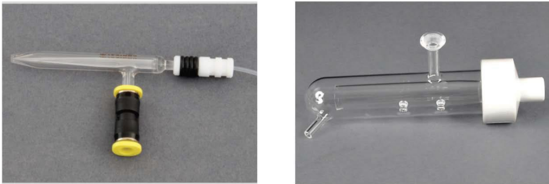
Рисунок 4.20 - Концентрический распылитель (слева) и распылительная камера (справа)»
