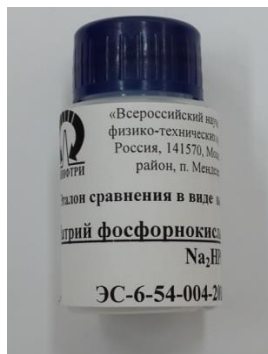
Рисунок 4.15 – Флакон с эталоном сравнения натрий фосфорнокислый двузамещенный (ЭСНФ)
