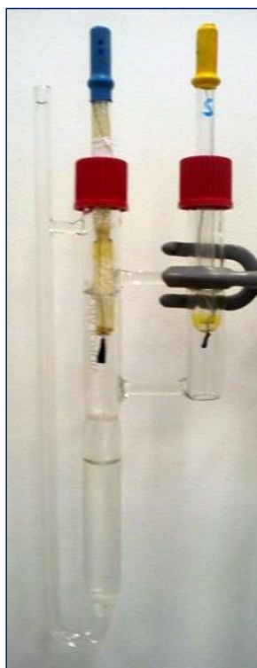
Рисунок 1.25 - Конструкция ячейки Харнеда, Бразильского метрологического института метрологии (INMETRO)
