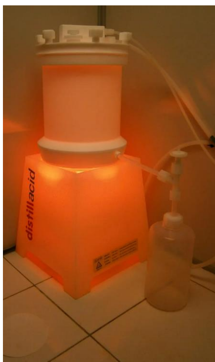
Рисунок 4.9 - Система очистки соляной кислоты
