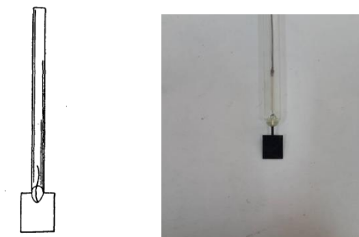
Рисунок 2.5 - Заготовка для водородного электрода.
