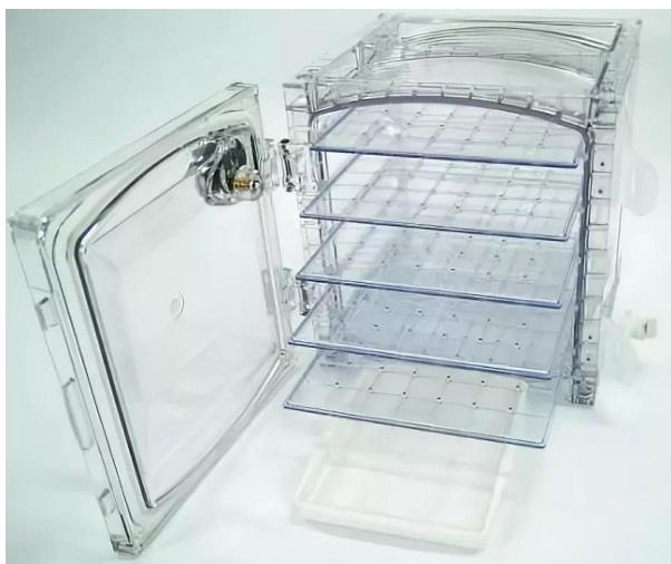
Рисунок 4.8 - Шкаф-эксикатор для удаления влаги из эталонов сравнения
