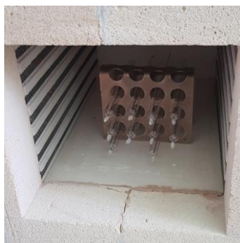
Рисунок 3.4 – Процесс обжига хлорсеребряных электродов в муфельной печи
