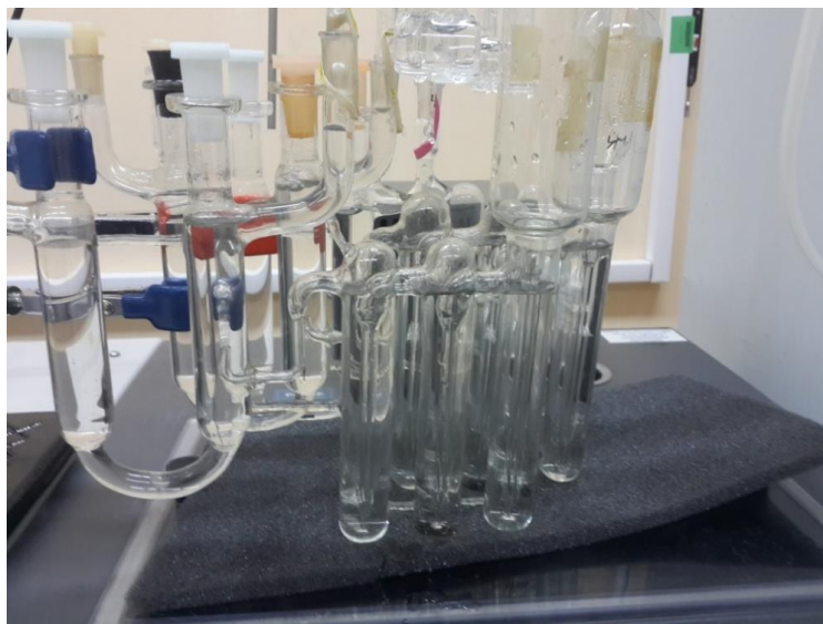
Рисунок 3.19 – Экспериментальный стенд для визуального определения расхода водорода в ячейку Харнеда
