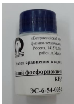
Рисунок 4.14 – Флакон с эталоном сравнения вещества калий фосфорнокислый однозамещенный (ЭСКФ)
