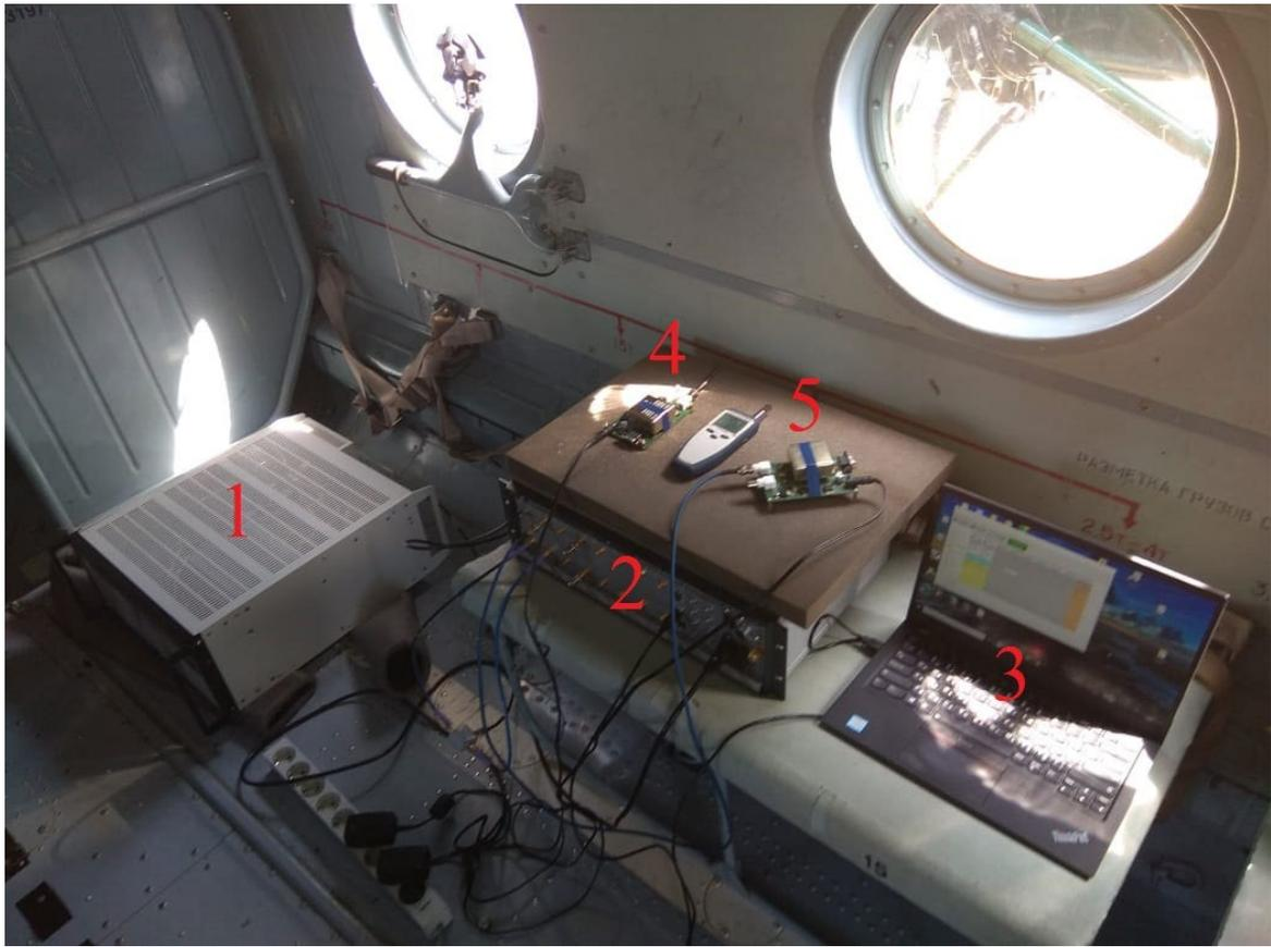
*Рисунок 39 - Испытательная установка на борту вертолѐта. 1 - водородный стандарт частоты, 2 - многоканальный фазовый компаратор, 3 - ноутбук, 4 и 5 - КСЧ КПН*
