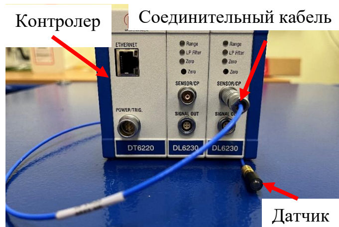
Рисунок 54 – Внешний вид емкостной системы измерения перемещения
