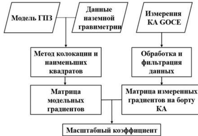
Рисунок 19 - Блок-схема оценки гравитационного градиентометра GOCE
