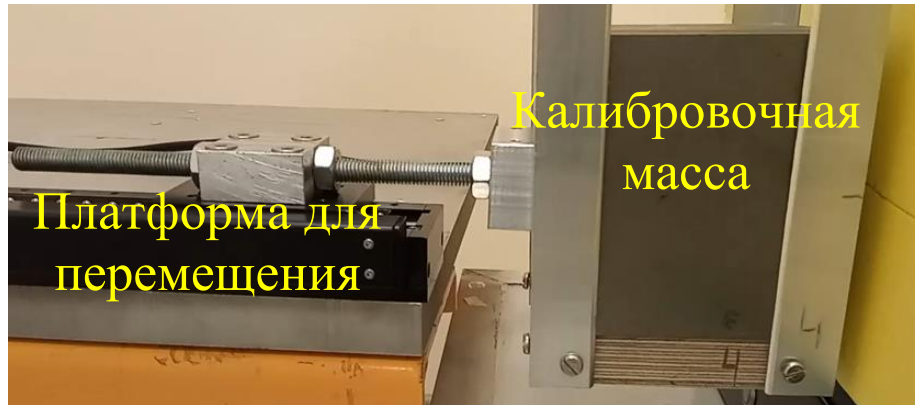
Рисунок 63 – Калибровочная масса и система его перемещения
