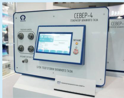
вер-4». Прибор предназначен для проведения поверки (калибровки) и градуировки гигрометров — измерителей относительной влажности, температуры точки росы и объемной доли влаги в газах и воздухе и найдет широкое применение в нефтегазовой, химической, атомной и других областях промышленности.
