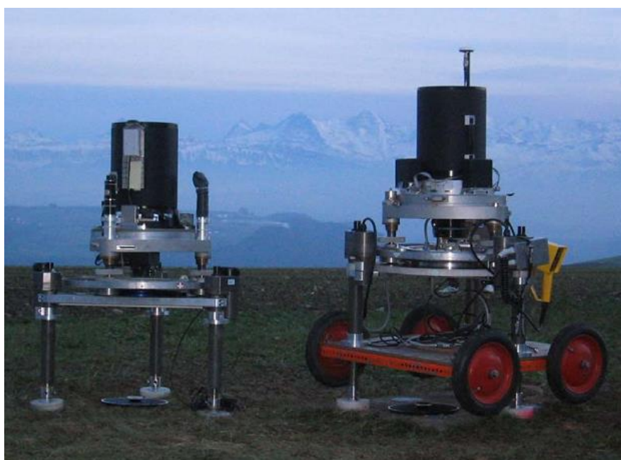
Рисунок 5. Внешний вид астроизмерителей: слева - университета Ганновера (TZK2-D); справа - Швейцарской Высшей Технической Школы Цюриха (DIADDEM)
