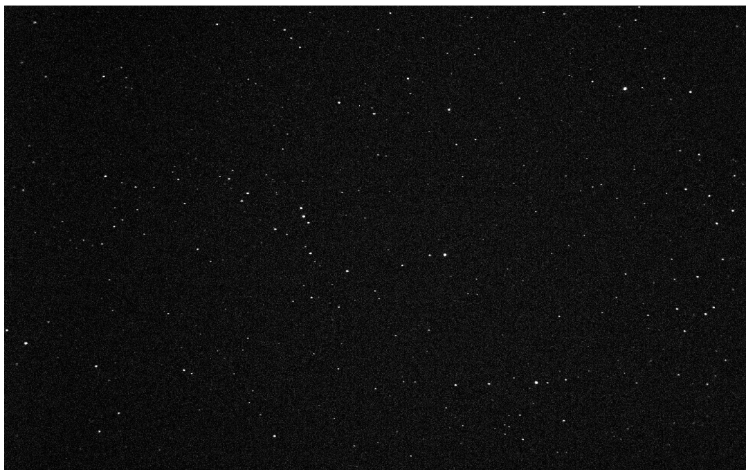
Рисунок 22. Пример кадра звездного неба, полученного со стендом на основе макета АУОЛ с временем экспозиции 0,5 с
