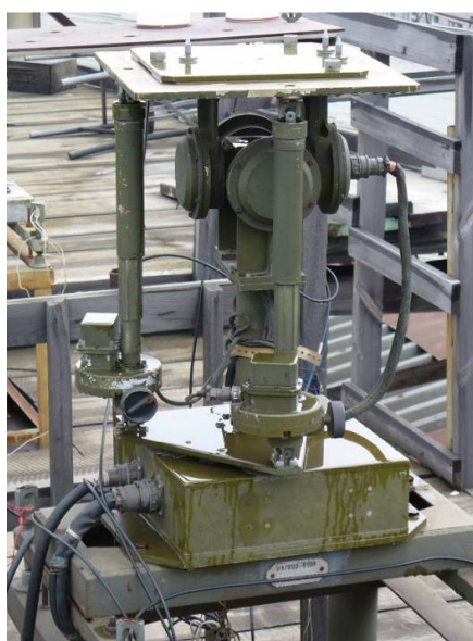
Рисунок 1.14 – Опорно-поворотное устройство с датчиками углового положения
