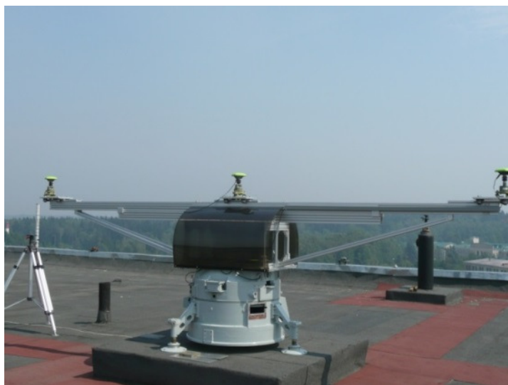
Рисунок 1.15 – Опорно-поворотное устройство с прецизионной механикой
