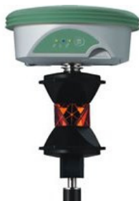
Рисунок 4.1 – Размещение отражателя под антенной УНАП
