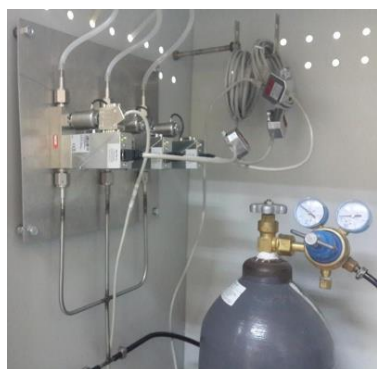
Рисунок 12 - Принципиальная схема системы точного дозирования водорода
