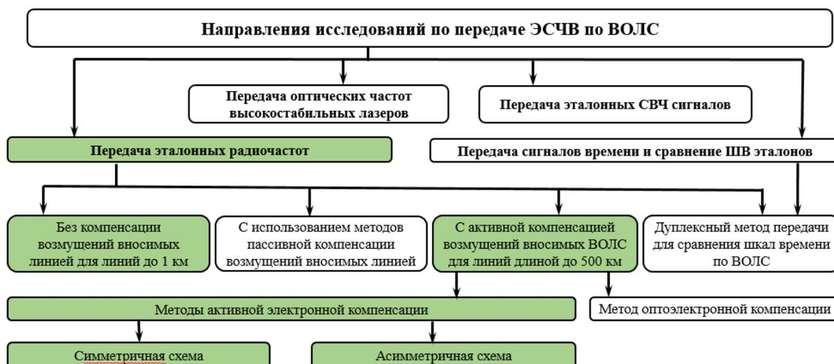
Рис. 1. Структура направлений исследований по проблеме передачи эталонных сигналов частоты по ВОЛС. Цветом выделены те методы, которые разрабатывал и исследовал соискатель
