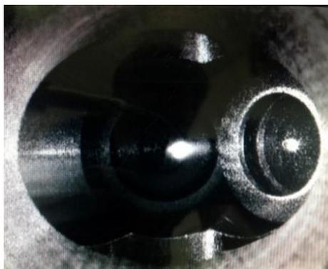
Рисунок 35 – Фотография облака холодных атомов  $Rb^{87}$  во вспомогательной ловушке. В правой части располагается зеркало с отверстием.
