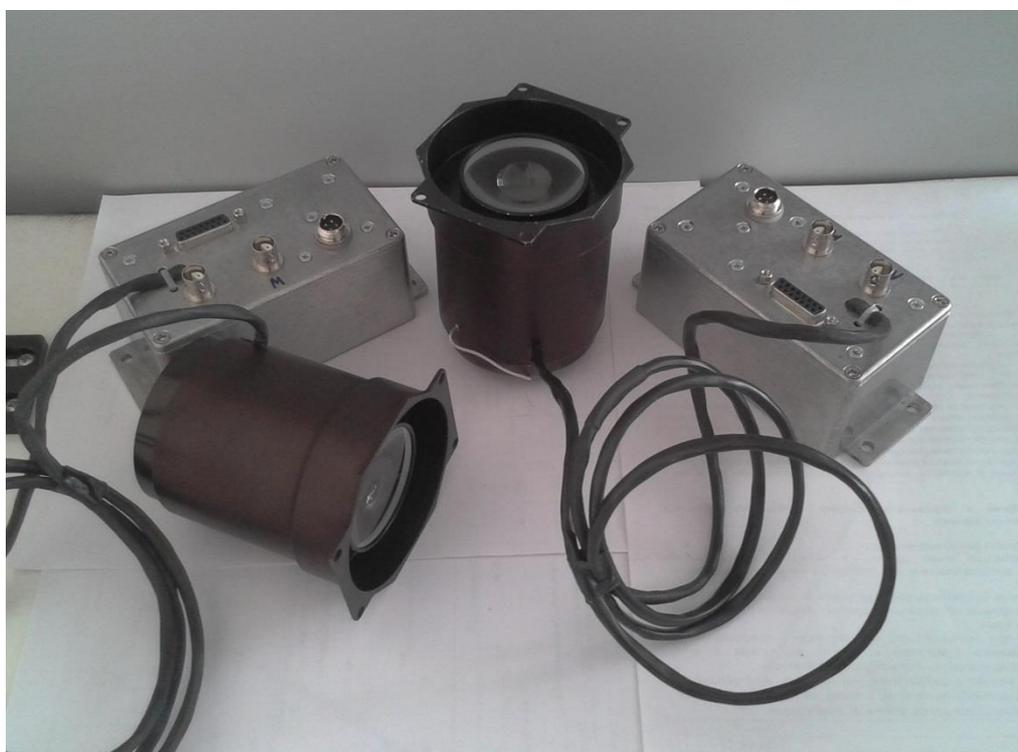
Рисунок 29 – Фотография двух фотодетекторов в сборе
