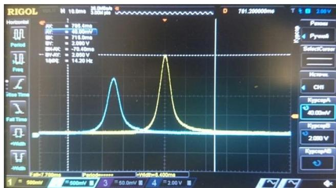
Рисунок 38– Сигналы детектирования атомов при работе вспомогательной ловушки в непрерывном режиме
