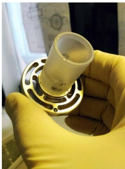
Рисунок 21 – Фото кварцевой втулки перед монтажом во фланец ловушки
