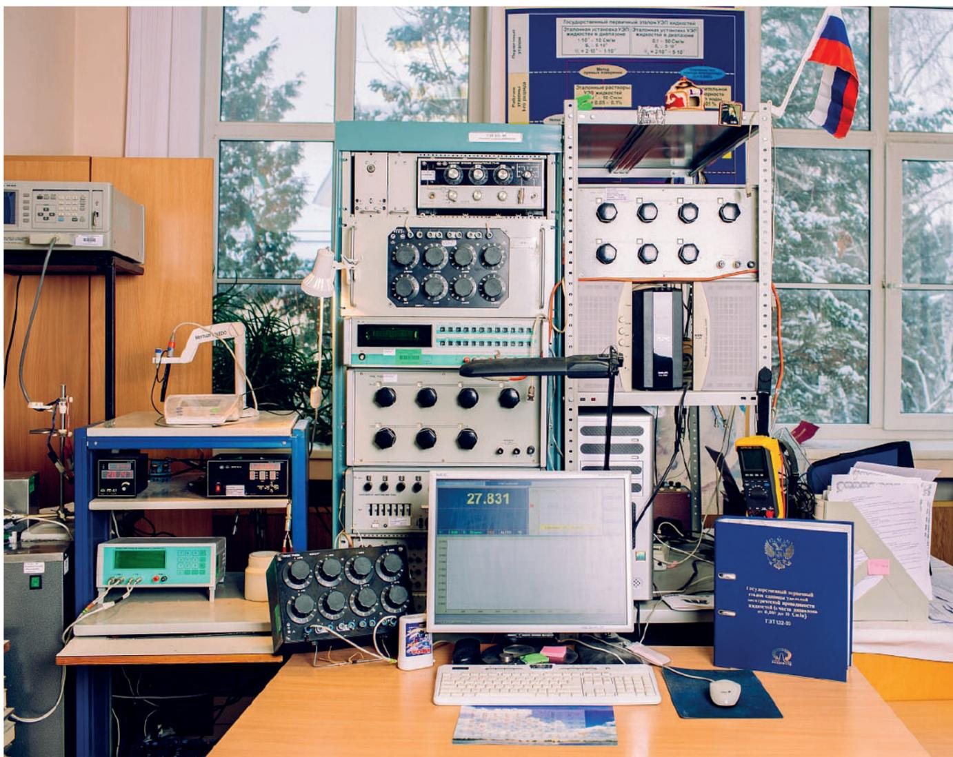
ГПЭ единицы удельной электрической проводимости жидкостей (в части диапазона от 0,001 до 10 См/м). ГЭТ 132
