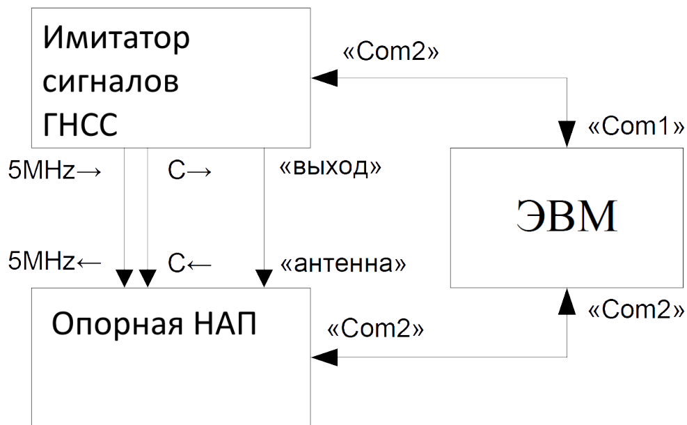
Рис. 2.3 – Схема измерений при калибровке имитатора сигналов с применением опорной НАП
