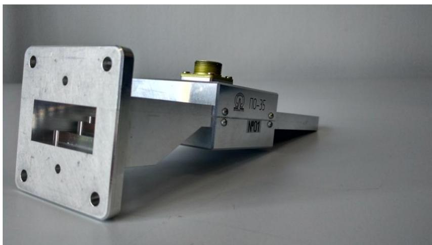
Рисунок 5 – Внешний вид преобразователя поглощаемой мощности
