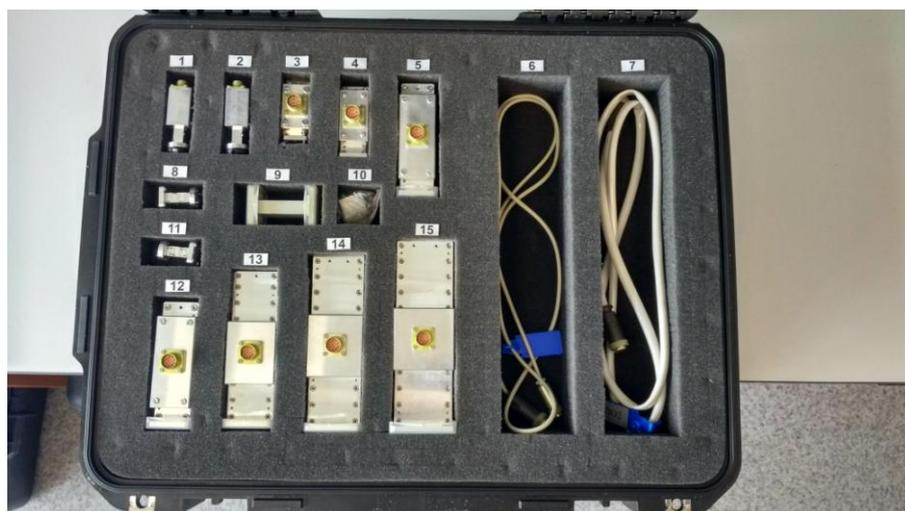
Рисунок 3 – Внешний вид кейса с преобразователями поглощаемой мощности
