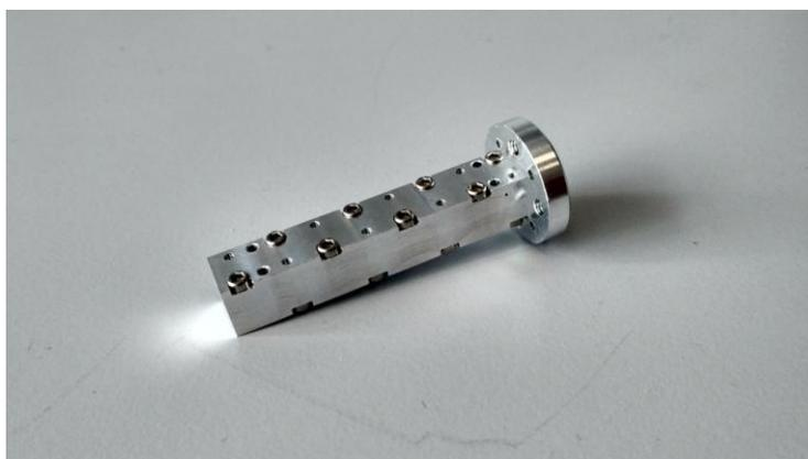
Рисунок 10 – Внешний вид нагрузки волноводной тракта сечением 3,6×1,8
