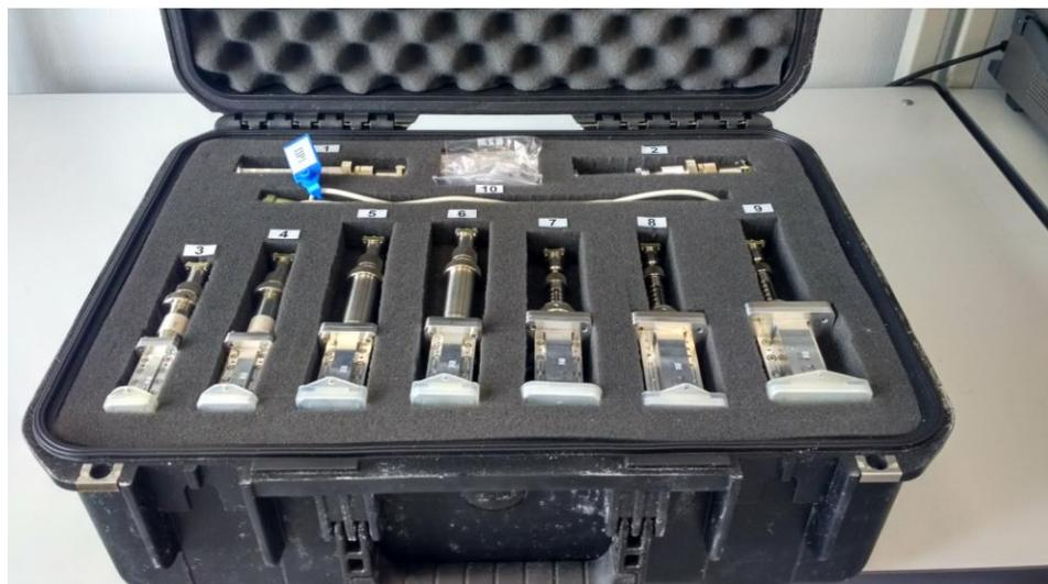
Рисунок 6 – Внешний вид кейса с индикатором мощности рассогласованным
