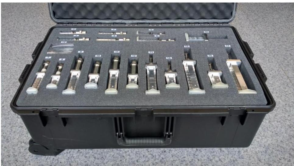
Рисунок 6 – Внешний кейса с комплектом калибровочных мер
